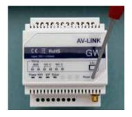
Verbinden Sie das Domo GW mit dem Domo-2-Draht-BUS System in Ihrer Anlage. **Die Anlage ist hierbei spannungsfrei zu schalten!**
